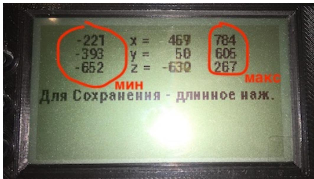
Суть калибровки заключается в нахождении минимальных и максимальных значений магнетометра. Для этого каждую из осей (X, Y, Z) необходимо направлять вдоль магнитных линий Земли.
